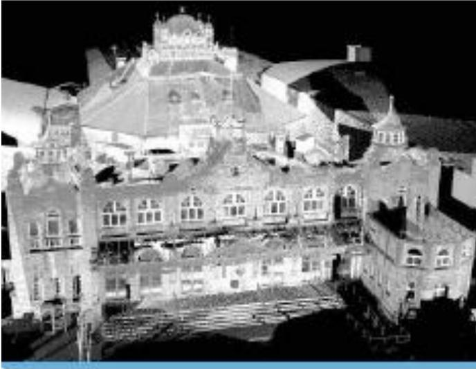
El montaje de los escáneres de alta velocidad sobre plataformas móviles, como enunciamos al principio de este trabajo, está creando una verdadera revolución en los levantamientos topográficos aplicados a la vialidad y al catastro. El equipo compuesto por dos escáneres montados sobre los laterales del techo de un vehículo, de tipo pick-up, con cámaras digitales, toman una película al mismo tiempo que los escáneres barren y guardan las nubes de puntos, el equipo completo es coordinado por un
