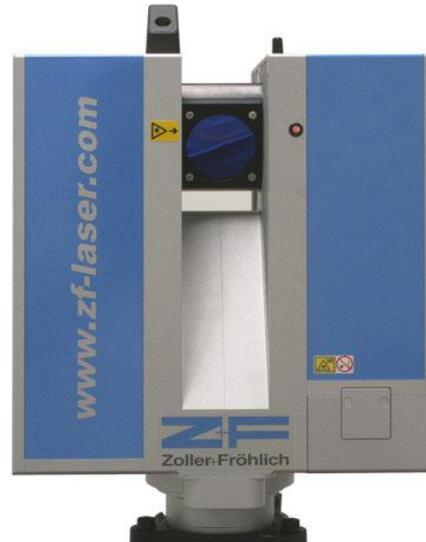
Su exactitud es de un par de milímetros, la velocidad de este escáner llega hasta 500.000 puntos por segundo, y podemos especificar resolución sub milimétrica, es decir, separación entre puntos, menor a un milímetro. Es muy usado para medición de deformaciones, en reactores nucleares, cortinas de presas, puentes y estructuras críticas, así como en el levantamiento y construcción, de aviones, barcos, submarinos y otros mega equipos.
