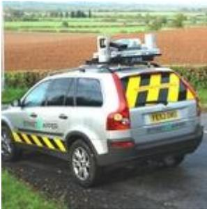
Cada escáner montado en el lateral del vehículo puede medir puntos a distancias de unos 200 metros, teniendo una visibilidad desde el centro de la vía, solapado por el otro escáner y su margen derecho o izquierdo correspondiente. En los casos de estudios de mantenimiento vial, se realizan repastos en la oficina de lo levantado metro por metro si se desea, con programas especiales, para visualizar y editar, y cuando se visualizan anomalías se considera el PK y situación específica del
