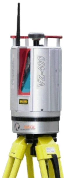
zonas de sombra debidas a la vegetación. El nuevo escáner láser Riegl VZ-400 es el primer escáner que usando Tiempo de Vuelo y LASER Clase 1, que alcanza velocidades de adquisición de 125.000 puntos / seg. Su gran alcance (> 500 m) y su precisión (+-4 mm), Y REPETIBILIDAD de +- 2mm, hacen de él un instrumento extremadamente versátil y adecuado, en numerosos campos de aplicación.
